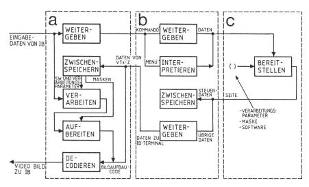
Fig. 4 Funktionen bei einer Session eines Personal Computers mit einer externen Datenbank a Terminal b VTx-Zentrale c Externe Datenbank
