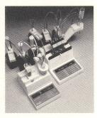
Moderne, mikroprozessorgesteuerte Instrumente automatisieren chemische Analysen – hier die Titration in der Nasschemie
