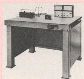
Kollimatoren, Laser- und Holographiegeräten, Spektrographen, Mikroschweissgeräten usw. wirken die minimalen, nicht spürbaren Eigenschwingungen von normalen Arbeitsflächen oft bereits verfälschend. Abhilfe wird vielfach mit schweren Tischplatten gesucht, denen Filz- oder Gummiplatten unterlegt werden: Dadurch ergeben sich die paradoxen Beispiele eines schlechten Wirkungsgrades von teuren Geräten. Der Isolair-Tisch löst diese Probleme. Mit Eigenfrequenzen von 0,5-4 Hz ergibt sich
