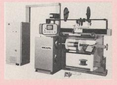
Die Bedienung der mit Mikrocomputertechnik und Bildschirmanzeige versehenen, programmierbaren Wickelmaschine MW-102 erfolgt im Dialogverfahren. Geeignet für Lagenund Scheibenspulen für Verteiltransformatoren von 50 bis 2000 kVA und in der Ausführung mit den üblichen Baugruppen. Ergänzungsbausteine sind möglich für Isolierpapier, Spulenrandstreifen, Drahtführer usw. Technische Daten:
