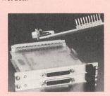
Die Lötanschlüsse der Kontakte benötigen nur Bohrungen von 0,7 mm Durchmesser. Die Kontaktoberflächen bestehen aus 0,8 µm Gold über 1,3 µm Nickel. Die HD-20-«Euro-Style»-Steckverbinder sind in 90°-und 180°-Ausführung mit und ohne metallische Erdungsstrei-
