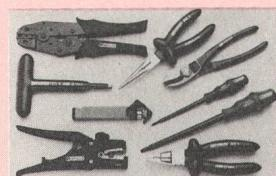
Das signalisiert augenfällig, dass bei einer Weiterverwendung des beschädigten Werkzeuges Lebensgefahr bestehen kann. Die «grünen» Mehrzweck-Zangen, Kabelschneider und Schraubenzieher der Elektro-Phönix AG entsprechen allen Sicherheitsnormen für Arbeiten unter Spannung bis 1000 V. Die Gebrauchsfähigkeit der isolierten Werkzeuge im Temperaturbereich von -20 °C bis +70 °C ist gewährleistet.
