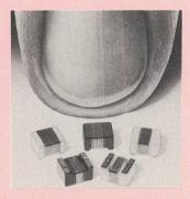
fertigt und mit Kontaktflächen zum direkten Auflöten oder Aufkleben versehen. Auf diese Kontaktflächen ist der löttemperatur- und waschflüssigkeitsbeständige Cu-Lackdraht der Wicklung geschweisst, um eine optimale Kontaktierung zu gewährleisten. Eine Anpassung des Kontaktmaterials an unterschiedliche Lötbedingungen kann auf Wunsch vorgenommen werden.
