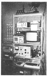
Fig. 6 Tieffrequenz-Plasma-Spektrometer in Versuchsaufbau
