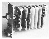
Fig. 2 Ein Kanal zum Erfassen von Blutdruck Vom links nach rechts: Transducer-Vorverstärker, Folgeverstärker, Auto-Tara, 3 Jumpers, Ausgangsmodul
