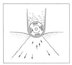
Fig. 3 Prinzip eines Sektor-Schallkopfes mit einem rotierenden Zylinder
