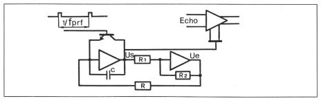
Fig. 7 Schéma électronique de l'amplification exponentielle de l'écho
