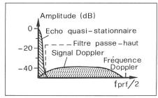
Fig. 8 Spectre des fréquences de l'écho démodulé
