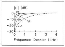
Fig. 12 Réponse fréquentielle du filtre passehaut de la figure 11
