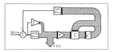
des 128 canaux nécessite une conversion analogique-digitale (A/D) très rapide ( $\approx 10$  MHz). D'autre part, le convertisseur A/D doit posséder une dynamique permettant de digitaliser le signal Doppler avec une résolution suffisante ( $\approx 30$  dB) lorsque le signal démodulé contient une composante quasi-stationnaire Q dont l'amplitude est de 30 à 50 dB supérieure à la composante Doppler.
