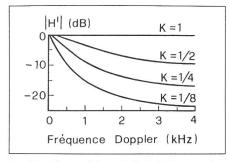
Fig. 13 Réponse fréquentielle du filtre passe-bas de la figure 11
