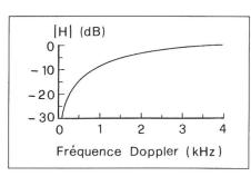
Fig. 10 Réponse fréquentielle du filtre passehaut de la figure 9
