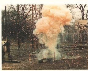
Zur Instruktion von Unfallverhütungsmassnahmen für VSE-Mitgliedwerke durchgeführte Kurzschlussversuche im Versuchsgelände der Panel S.A., Préverenges VD
