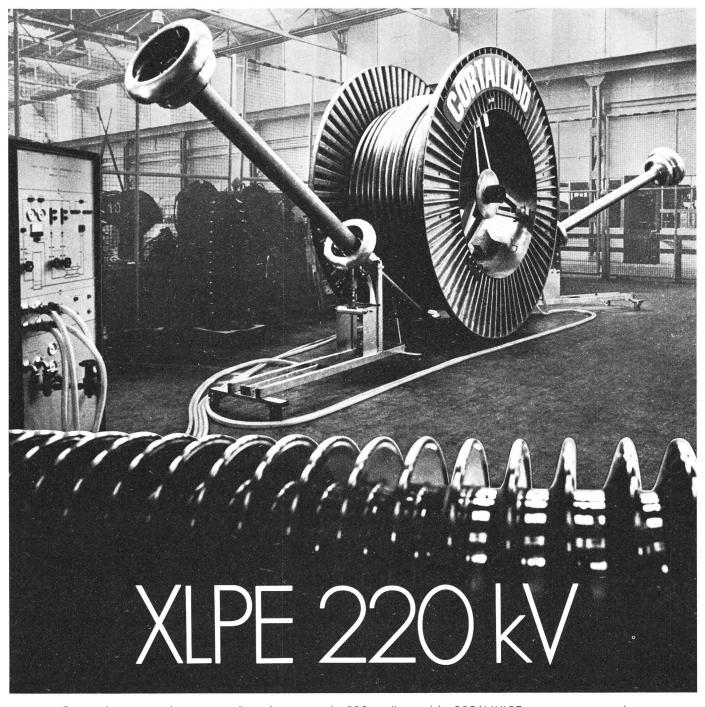
Essais de routine de tension, d'une longueur de 500 m d'un câble 220 kV XLPE avant son expédition.
