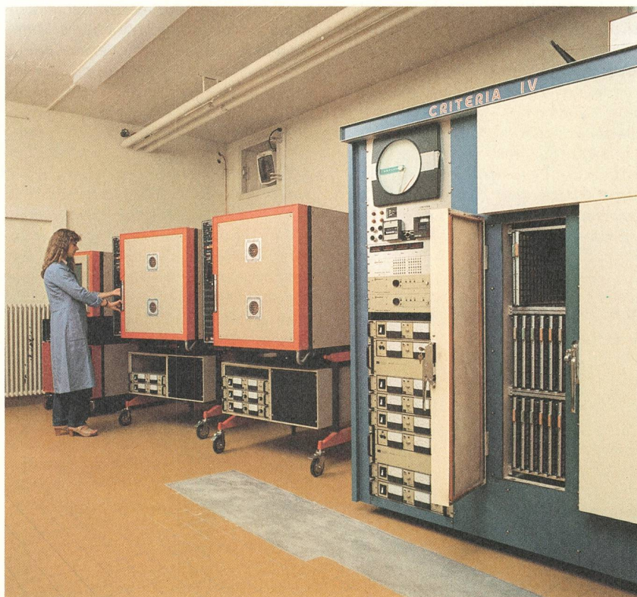
Einrichtungen zur Vorbehandlung elektronischer Komponenten nach MIL beim Schweizerischen Komponentenprüfzentrum ASE/CSEE in Neuenburg
