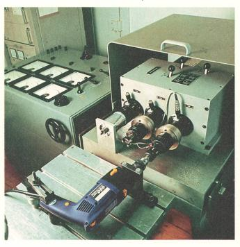
Handwerkzeugprüfung: Messung der aufgenommenen Leistung und der Erwärmung
