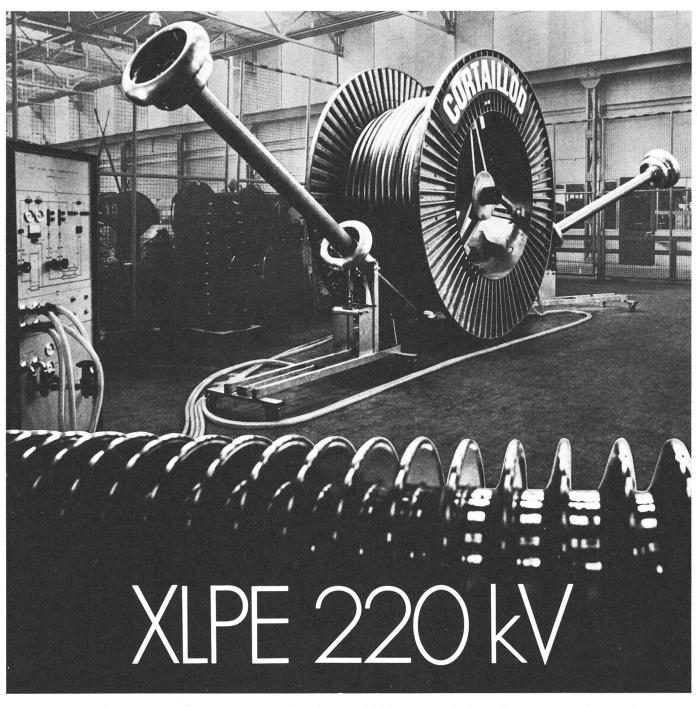
Spannungsprüfung an einem 500 m langen 220 kV-XLPE-Kabel vor dessen Versand.
