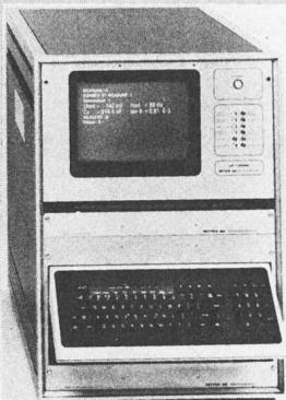
häuse und besteht aus dem eigentlichen Brückenteil, dem Mikrocomputer, dem Bildschirm mit Tastatur (die herausgeklappt werden kann). In Dialogtechnik werden die Größen des Vergleichsnormales, des Prüflings usw. eingegeben. Die Messung erfolgt vollautomatisch, und es bestehen zusätzliche Optionen für eine Fernsteuerung, für den Datenaustausch, den Anschluss eines Druckers usw.
