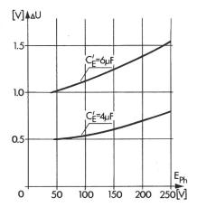
Fig. 1 Abhängigkeit des Spannungsfehlers der Brückenschaltung  $\Delta U$  von der Phasenspannung des Wechselstromerregers  $E_{\rm Ph}$
