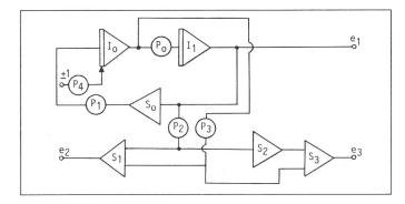
composé d'un intégrateur (I), de deux potentiomètres (P) et une non-linéarité simulée à part. Le sommateur (So) permet la sommation des trois courants qui seront intégrés par l'intégrateur ( $I_3$ ) pour avoir la tension ( $-V_c$ ). Le potentiomètre ( $P_8$ ) permet le réglage de la condition initiale sur la capacité.
