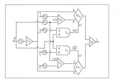
Fig. 5 Schéma de la simulation de la non-linéarité
