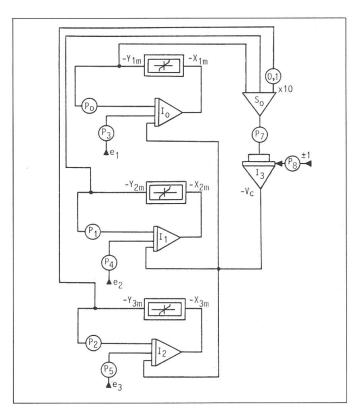
rig. 2 Schéma de la simulation globale de la ferrorésonance tri-monophasée
