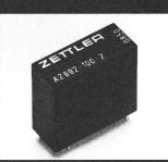
Robuste Schaltrelais nach den Sicherheitsvorschriften SEV,UL, CSA, VDE, SEMKO, DEMKO, BS. Kriechund Luftstrecken mit >8 mm und Prüfspannung 4 kV. Isolationsaufbau nach VDE 0110. Brennbarkeitsklasse V-0 nach UL-94. Max. 2 Wechsler, Öffner oder Schliesser bis max. 16 A (max. 380 V~). Dichte Ausführungen nach IP 67 DIN 40050. Passende Steckfassungen lieferbar. Informieren Sie sich unverbindlich.
