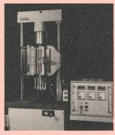
turen bis max. 1150 °C hat die Carl Schenck AG, Darmstadt, die Hochtemperatur-Prüfeinrichtung TA entwickelt. In Verbindung mit einer Prüfmaschine können Zeitstand-, Warmzug-, Spannungswechsel- und Dehnwechsel-Versuche durchgeführt werden. Hauptbestandteile der Prüfeinrichtung sind der Hochtemperatur-Ofen TAO und die mit Mikroprozessoren ausgestattete Temperatur-Mess- und -Regeleinrich-tung TAS. Das Regelgerät ist entweder als Tischversion oder als Schaltschrankeinschub lieferbar.
