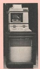
ein vollständig integriertes, schnelles, analoges System für Messungen von Spannungen, Strom und/oder Widerstand in mehreren Messkanälen, das in industriellen Automatisierungssystemen sowie in computergestützten Testanwendungen eingesetzt werden kann. Es erlaubt eine einfache Anpassung an automatische Test- und Steuersysteme und eignet sich für Prozess- und Anlagenüberwachung, Eingangskontrolle, Produktionstest, BaugruppenTest, Umgebungstest und Schwingungsanalyse.
