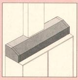
förmige Kanäle, bestehend aus mindestens zwei Haltern, einem Abdeckprofil und Endplatten. Sie sind in zwei Grössen für Überdeckungsbreiten von 110 oder 150 mm und für 150 oder 190 mm ausgelegt. Die Montage des Rangierkanals ist einfach.
