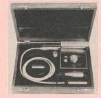
Das typische Grundgeräusch des kompletten Messsystems beträgt -2,5 dB (A). So können zwischen 20 Hz und 12,5 kHz ½-Oktavbandmessungen bis zu -15 dB durchgeführt werden. Der Frequenzgang des 4179 zusammen mit 2660 entspricht der IEC-Norm 651, Klasse 1.
