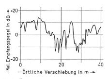
Fig. 4 Örtlicher Verlauf des Empfangspegels bei 96 HMz, in 3 m Höhe und innerhalb einer grösseren Ortschaft
