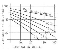
Fig. 2 Ausbreitungskurven für f = 100 bis 300 MHz
