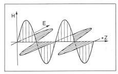
Fig. 1 Elektrisches und magnetisches Feld einer sich in Richtung von + Z fortpflanzenden Welle
