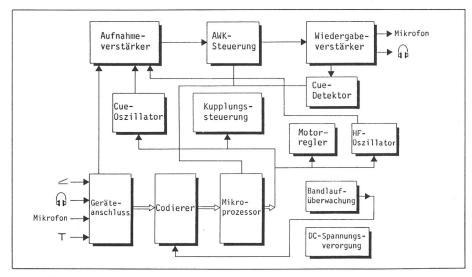
Fig. 7 Blockschaltbild eines Diktiergerätes
