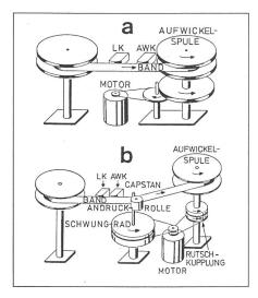
**Fig. 2 Diktiergeräteantrieb** a ohne Capstan
