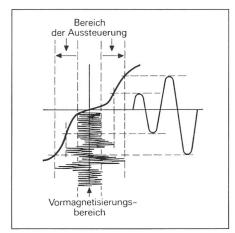
Fig. 5 Prinzip der Vormagnetisierung
