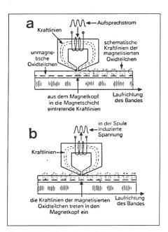
Fig. 4 Magnetische Tonspeicherung
