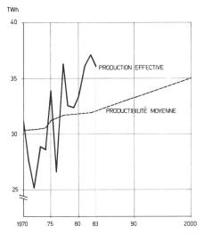
Fig. 8 Augmentation prévue de la productibilité des centrales hydrauliques
