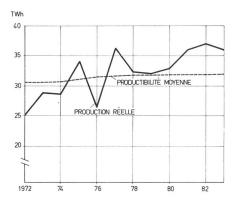
Fig. 1 Production des usines hydrauliques
