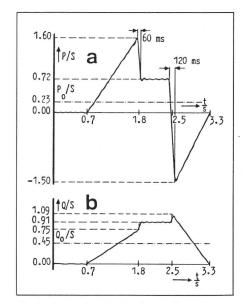
Fig. 1 Lastverlauf des Synchro-Zyklotrons a Wirklast P/S = f(t)b Blindlast Q/S = f(t)mit S = 100 MVA
