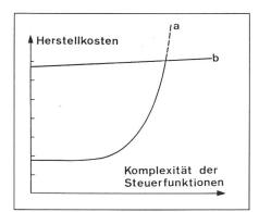
Fig. 2 Herstellkosten der Steuerung Kurve a konventionelle Steuerung Kurve b elektronische Steuerung
