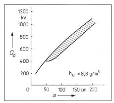
Fig. 5 Durchschlagspannung  $\bar{U}_{\rm d}$  der Stab-Stab-Funkenstrecke in Abhängigkeit vom Abstand a bei beiden Polaritäten der Gleichspannung
