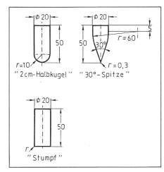
Fig. 4 Massskizze der verschiedenen Abschlusselektroden
