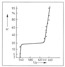
Fig. 6 Summenhäufigkeit H der Durchschlagspannung  $U_{\rm d}$  der negativen 100-cm-Stab-Stab-Funkenstrecke
