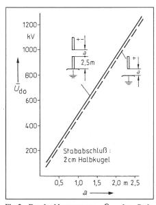
Fig. 2 Durchschlagspannung  $\bar{U}_{d0}$  der Stab-Stab- und Stab-Platte-Anordnung
