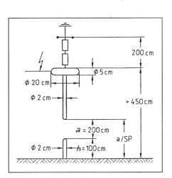
Fig. 8 Vorschlag für eine genormte Stab-Stab-Funkenstrecke
