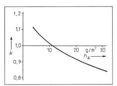
Fig. 1 Korrekturfaktor k in Abhängigkeit der absoluten Feuchtigkeit  $h_a$
