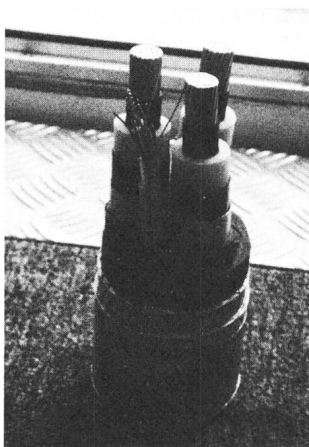
Fig. 1 Modell des verwendeten Seekabels
