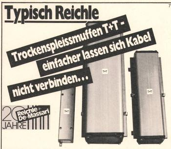
Das bietet nur Reichle: die neue, problemlose Art der Verbindung von Installationskabeln mit einem Aderndurchmesser von 0,4–0,6 mm. Denn mit der Reichle-Trockenspleissmuffe geht alles um ein Vielfaches leichter: mit den Reichle-Sortierringen werden die Adernpaare zusammengefasst – Verbinder aufgesetzt – mit Verbinderzange zugedrückt – fertig.
