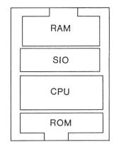
Fig. 2 Anordnung der Baugruppen auf dem Chip
