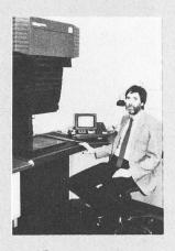
Die Bedienerführung erfolgt über ein Bildschirmterminal, das alle Arbeitsschritte in einer Bedienungsanleitung im Klartext angibt. Alle Daten werden zentral gespeichert, stehen zur späteren Wiederholung zur Verfügung und können archiviert werden. Im Color-Fachlabor ermöglicht das standardisierte Verfahren einen hohen Oualitätsstandard für Colorduplikate und Zusammenkopierung. (Alos AG, 8045 Zürich)
