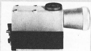
Ein modulierter, ultravioletter Lichtstrahl wird auf das zu prüfende Objekt gerichtet. Gelangt ein fluoreszierender Gegenstand in diesen Strahl, so wird dieser zum Leuchten im sichtbaren Bereich angeregt. Diese Lumineszenz wird vom UV10 empfangen und ausgewertet. Stark reflektierende (aber nicht fluoreszierende) Flächen wie Chrom, Glas oder polierte Metalle haben keinen Einfluss auf den Prüfvorgang im Empfänger.
