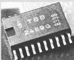
Im TBB 2469 gelang das Eingangssignal über einen HF-Vervielfachter an einen quarzgesteuerten Mischkreis. Nach externer Selektion folgt ein Begrenzerverstärker und anschließend ein Koinzidenzdemodulator. Die NF wird einem Tiefpass zugeführt, dem sich ein doppelter NF-Vervielfachter anschliesst: Die Verstärkung und der Frequenzgang des ersten Vervielfachters können extern eingestellt werden; dadurch lassen sich unvermeidliche Streuungen der Serienproduktion ausgleichen. Der zwei-
