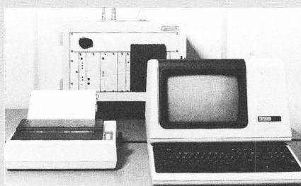
Das Rundsteuer-Kommandogerät FPR3 eignet sich für kleine bis mittlere Rundsteuersysteme SEMAGYR und wird in zwei Grundausführungen geliefert: FPR3 S für den Einsatz als Zentralautomatik, FPR3 P als Lokalautomatik.
