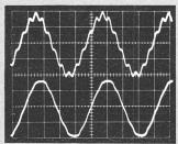
Waschmaschinen usw. verwenden die Elektrizitätswerke Tonfrequenzsignale, welche der Netzspannung überlagert werden. Diese Netzkommandosignale führen häufig zu Störungen bei anderen empfindlichen Verbrauchern, die ebenfalls dem öffentlichen Netz angeschlossen sind. Der einwandfreie Betrieb solcher Verbraucher ist nur durch eine «saubere» Stromversorgung, resp. durch das Vorschalten eines
