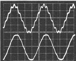
Waschmaschinen usw. verwenden die Elektrizitätswerke Tonfrequenzsignale, welche der Netzspannung überlagert werden. Diese Netzkommadosignale führen häufig zu Störungen bei anderen empfindlichen Verbrauchern, die ebenfalls dem öffentlichen Netz angelassen sind. Der einwandfreie Betrieb solcher Verbraucher ist nur durch eine «saubere» Stromversorgung, resp. durch das Vorschalten eines
