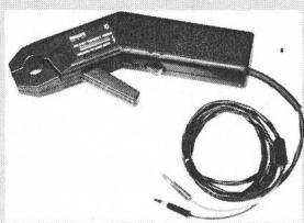
Wird die Stromzange an ein Oszilloskop angeschlossen, ist die Kurvenform des Stromes ersichtlich. Einzige Begrenzung ist die bei etwa 5 kHz liegende Bandbreite der Stromzange.
