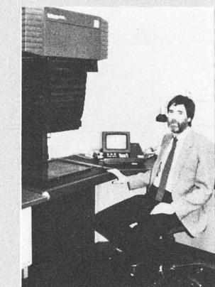
Die Bedienerführung erfolgt über ein Bildschirmterminal, das alle Arbeitsschritte in einer Bedienungsanleitung im Klartext angibt. Alle Daten werden zentral gespeichert, stehen zur späteren Wiederholung zur Verfügung und können archiviert werden. Im Color-Fachlabor ermöglicht das standardisierte Verfahren einen hohen Qualitätsstandard für Colordu-
