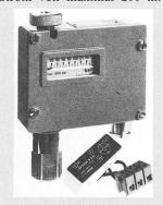
Innerhalb von -0,9...400 bar stehen 20 Messbereiche zur Verfügung. Anstelle des mechanischen Mikroschalters kommt ein induktiver Näherungsschalter zur Anwendung, welcher auch in feuchter Umgebung einwandfrei arbeitet, da er vollständig gekapselt ist. Alle Druckschalter entsprechen der Schutzart IP 65.
