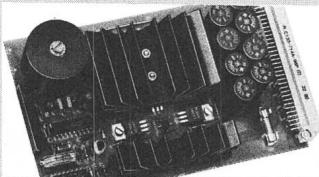
Dank dem Einsatz moderner Schaltungstechnik mit Leistungs-FET liegt der Wirkungsgrad des Reglers je nach Ausgangsspannung bei 75...95%. Die geringe Wärmeentwicklung steigert die Zuverlässigkeit der Schaltung. Die Typen DWV-10 und DWV-11 liefern im ganzen
