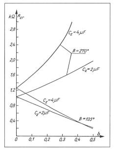
Fig. 4 Abhängigkeit des Ansprechwiderstandes der Abschaltstufe des Impedanzschutzes von der induzierten Spannung in der Welle, bezogen auf die Polarisationsspannung des Schutzes  $(b = U_{\rm w}/U_{\rm p})$
