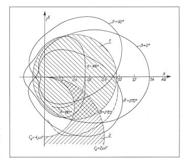
Fig. 2 Ansprechcharakteristiken der Abschaltstufe des Impedanzschutzes bei  $U_{\rm W}=25~{\rm V}$
