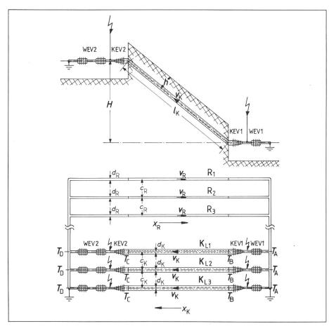
Fig. 1 Kabel mit Kühlrohr im Leiter und Kühlwasser-Rückführungsrohre in einer Gefäll-Trasse Die Endverschlüsse sind alle horizontal montiert. Die Spannungspfeile kennzeichnen die elektrischen
