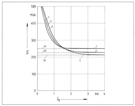
Fig. 6 Übertragungsleistung S von Kabeln ohne Gefälle, aber mit Steilstrecken, in Abhängigkeit von der Kabellänge  $I_K$
