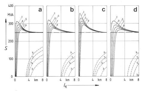
Fig. 2 Übertragbare Leistungen S in Abhängigkeit von der Kabellänge  $I_K$  bei schräg liegenden Kabeln mit einer Höhendifferenz H zwischen Anfang und Ende von 40 m (durchgezogene Kennlinien)
