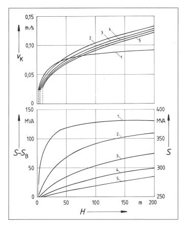
Eigenkühlung in Abhängigkeit von der Höhendifferenz H der Anlage Anordnung nach Figur 3b. Elektrische Leitfähigkeit des Kühlwassers 1 uS/cm bei 20 °C. Kabel: Hohlkanaldurchmesser 55,1 mm, Verlegetiefe 1200 mm. Aderachsabstand 400 mm, zugestandene Bodenaustrocknung. Hohlkanaldurchmesser 82,5 mm, Verlegetiefe 600 mm, Achsabstand 600 mm, thermisch stabilisierter Graben. Parameter der Kennlinien: Kabellänge in km.
