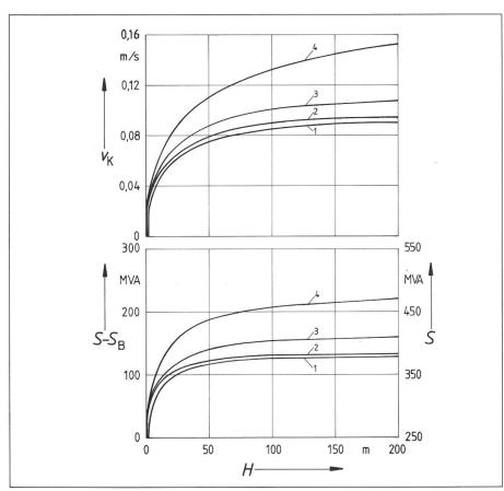
Fig. 5 Kühlwassergeschwindigkeit v<sub>K</sub> in einem 1 km langen Kabel und dessen Leistungsüberhöhung (S-S<sub>B</sub>) in Abhängigkeit von der Höhendifferenz H zwischen Kabelanfang und Kabelende
