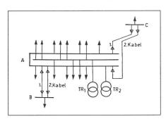
Fig. 6 Verschiedene Anschlussmöglichkeiten paralleler Kabel zwischen zwei Unterwerken
