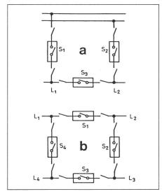
Fig. 8 Prinzip der 1½-Schalter-Anordnung (a) bzw. der Ringanordnung (b)
