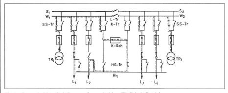
Fig. 1 Sammelschiene S als Reserve; Sammelschiene W allein in Betrieb
