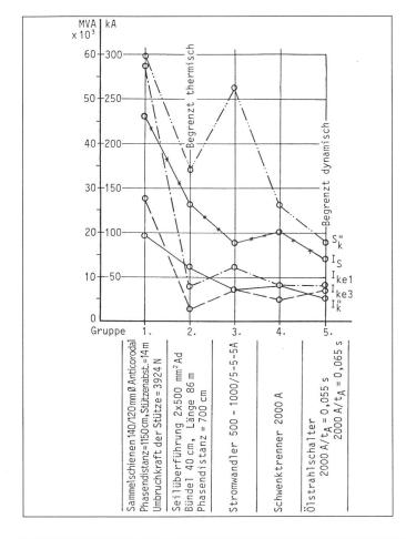
Fig. 5 Kurzschlussfestigkeit einer Freiluftschaltanlage 380 kV
