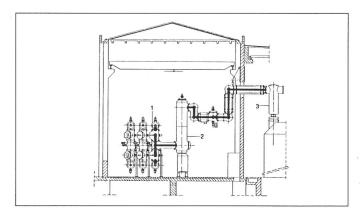
Fig. 7 Transformatorschaltfeld mit Doppelsammelschiene
