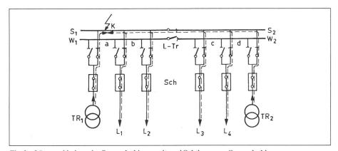
Fig. 3 Längsverbindung der Sammelschienen mit zwei Sektionen pro Sammelschiene Die Längstrenner ermöglichen verschiedene Zuordnungen von Transformatoren und Feldern. Ein Kurzschluss in K setzt aber beide Sektionen S<sub>1</sub> und S<sub>2</sub> ausser Betrieb. Der Bereich a wird maximal belastet.
