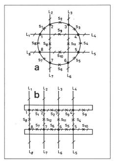
Fig. 9 Ring-Kreuz-Anordnung mit Leitungen  $L_1...L_8$
