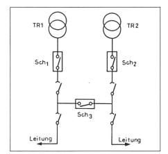
Fig. 11 H-Schaltung ohne Sammelschiene
