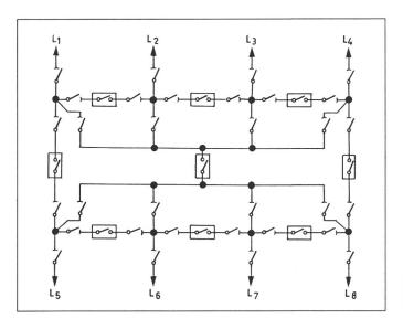
Fig. 10 Ringanordnung mit Überbrückungsschalter
