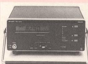
matisch passive Schaltelemente. Die einzelne Messung läuft infolge einer Mikroprozessorsteuerung vollautomatisch ab: Das Gerät bestimmt selbstständig, ob es sich bei dem zu messenden passiven Bauelement um einen Widerstand R, eine Kapazität C oder eine Induktivität handelt. Der Wert wird hierauf auf einer vierstelligen LCD-Anzeige angezeigt. Weder Parameter- noch Messbereichseinstellungen sind vor der Messung erforderlich. Als zusätzliche Information wird nach der Messung das Ersatzschaltbild
