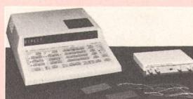
des zu prüfenden Bauelementes auf dem Display dargestellt. In Abhängigkeit des Gütefaktors  $Q$  und des Verlustfaktors  $d$  werden die Wirk- und Blindkomponenten in symbolischer Reihen- oder Parallelschaltung von  $R, L$  oder  $R, C$  angezeigt. Ihr numerischer Wert kann – wie auch  $Q, d$  und der Scheinwiderstand  $Z$  – nach Wunsch aufgerufen werden.
