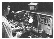
Mit einem automatischen Bonder werden die Verbindungen zwischen dem Chip und den Anschlusskontakten hergestellt. Die Bedienungsperson verfolgt den Vorgang auf dem Bildschirm am stark vergrösserten Chip
