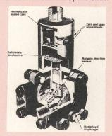
le: Die Gould-Transmitter messen hier Drücke in den drei Hauptraketenmotoren der Fähre, in den Steuerungs- und Stabilisierungsdüsen, in den übrigen Brennstoff- und den verschiedenen hydraulischen Systemen und in den Kontrollsystemen für die Steuerung und Überwachung.
