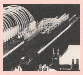
Montage erfolgt auf TS 32. Für den Einsatz im Bereich der Leistungstechnik ist der Typ KMVF mit Flachstecker 6,3×0,8 mm nach DIN 46244. Für den Einsatz im Bereich Leittechnik der Typ KMVT mit Klammerstift 0,8×2,4 mm nach DIN 41611. Bei der KMVF beträgt die Nennspannung 250 V~ Gr. C, der Nennstrom 16 A, die Klemmenbreite 6 mm und der Nennquerschnitt 2,5 m2. Bei der KMVT beträgt die Nennspannung 250 V~ Gr. C, der Nennstrom 6 A, die Klemmenbreite 6 mm und der Nennquerschnitt AWG 20.
