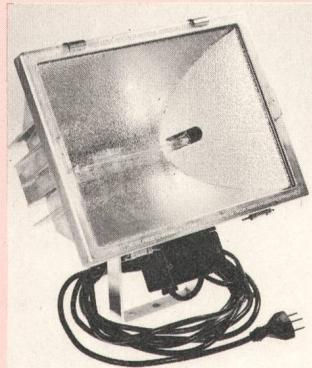
Reflektoren ergeben hohe Lichtausbeute bei relativ geringer thermischer Beanspruchung aller Leuchtenbestandteile. Das Sicherheitshartglas hält auch extreme Temperaturschwankungen stand. Die Strahler können fest montiert oder als transportable Beleuchtungseinheiten verwendet werden. Geometrisch günstig angeordnete Befestigungsbügel ergeben problemlose Einstellmöglichkeiten. Die Lampen können ohne Werkzeuge gewechselt werden. (F. Knobel, 8755 Ennenda)
