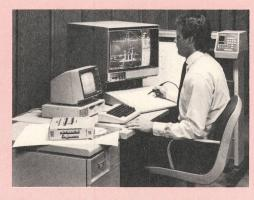
laubt das Erstellen von Schaltplänen, Leiterplatten-Layouts und modular aufgebauten technischen Zeichnungen. Der Anwender arbeitet mit Bildschirmtext, Grafiktisch oder Tastatur. Der Einsatz dieser Anlage ist für den technisch-wissenschaftlichen Bereich zugeschnitten. Im System sind Module für vier Hauptanwendungen enthalten:
