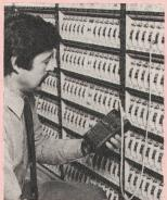
und Ölgesellschaften und Elektrizitätswerken eingesetzt. Sein grosser Frequenzbereich reicht von 30 Hz-120 kHz und ermöglicht auch die Messung des Leistungspegels von Primärgruppen. Mit einem eingebauten Sender, welcher bei einer Festfrequenz von 820 Hz einen Ausgangspegel von -10 dB/dBm an einem symmetrischen 600-Ω-Ausgang abgibt, lassen sich Messungen an einer ausser Betrieb befindlichen Strecke oder Schleifenmessungen durchführen.
