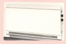
Die im «juratherm»-Flachspeicher verwendete Steuerungselektronik orientiert sich ausschliesslich an der Raumtemperatur. Aussenfühler erübrigen sich, da sich das Regelorgan direkt im Gerät befindet. Schwankungen der Raumtemperatur werden sofort ausgeglichen. Nachts erfolgt eine automatische Temperaturabsenkung. Mehrere Speichergeräte im selben Raum können von einer einzigen Elektronik, die
