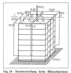
zept mit zweiter «Haut» (zusätzliche Dach- und Fassadenkonstruktion)
