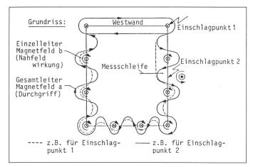
Fig. 11 Vereinfachter Grundriss des Fernmeldegebäudes «Ittigen» mit Magnetfeldlinien
