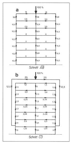
Fig. 15 Stromverteilung im Inneren der Gebäude
