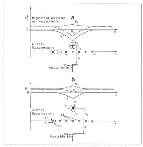
Fig. 10 Einfluss der Rückleiterhöhe h auf das resultierende Feld (Hm) in einer Schleife in festem Abstand avom Gitter
