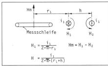
Fig. 8 Magnetfeldrichtungen bei Einzelleiter
