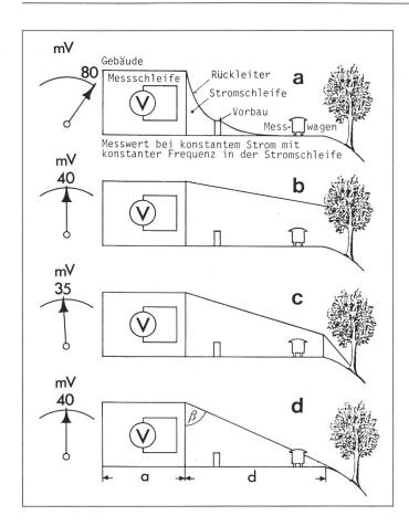
Fig. 7 Einfluss des Rückleiterdurchhangs auf das Messergebnis
