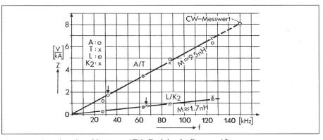
Fig. 5 Kopplungsimpedanz-Messungen (Z) in Funktion der Frequenz (f)
