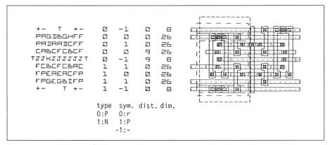
Fig. 10 Traduction et layout géométrique du registre C<sup>2</sup>MOS
