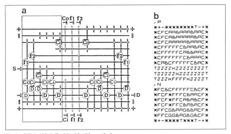
Fig. 5 Cellule 1 bit de l'unité arithmétique et logique a Layout symbolique b Fichier alphabétique
