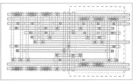
Fig. 9 Layout géométrique de la cellule unité arithmétique et logique
