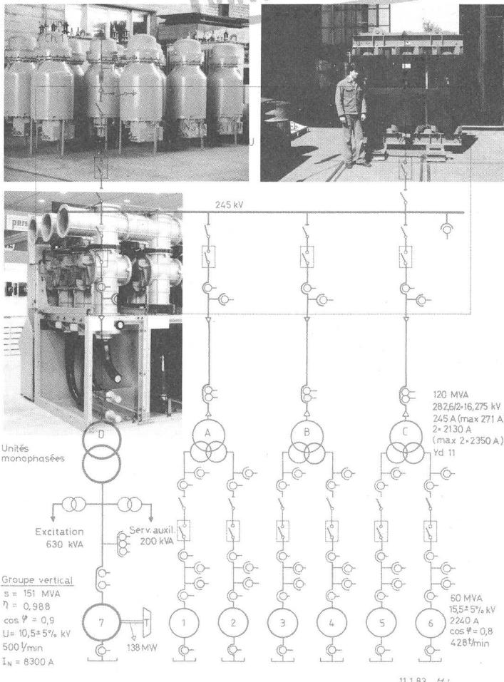
Wir projektiert und liefern systemgeschlossene Anlagen als Verbindung von Generatoren zu Transformatorenbänken, zu Schaltfeldern und als Sammelschienen:
