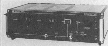
siko des «second breakdown» in einem grossen Spannungsbe- reich über zwei Dekaden bis 400 V belasten. Die Stromanstieg- und -Abfallzeiten bei Pulsbetrieb liegen im Bereich weniger  $\mu$ s. Es eröffnen sich so-
