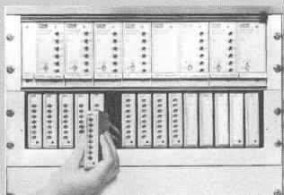
zusätzliche Entzerrungsschaltungen, wodurch über das Frequenzband von 15 kHz bis 5,5 MHz eine Welligkeit der Signalamplitude von  $\pm 0,05$  dB erreicht wird. Der Wellenwiderstand beträgt in allen Ausführungen 75 Ohm. Die Rückflussdämpfung ist auch hier besser als 27 dB. Zur Erreichung grösserer Verzögerungszeiten können diese Module in Reihe geschaltet werden.
