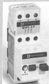
sen auf 25 A/380 V erweitert worden. Das hohe strombegrenzende Schaltvermögen von 6 kA/380 V wird durch einen Is-Begrenzer GV1-L, der sich an die Geräte von 10 bis 25 A anbauen lässt, auf 50 kA/380 V bei  $\cos\phi = 0,7$  erhöht. Die
