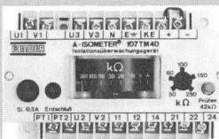
liertes Netz. Die Trennung erfolgt durch entsprechende Isolier-Trenntransformatoren. Die Schutzwirkung beruht auf der Tatsache, dass sowohl bei der Berührung einer Phase als auch bei der Berührung eines unter Spannung stehenden Anlageteiles kein gefährlicher Berührungsstrom zum Fliessen kommt. Das Isolationskontrollgerät 107 TM 40 überwacht während des Betriebes den Isolationszustand des Netzes gegen den gemeinsamen Schutzleiter bzw. Erde und meldet im Fehlerfall den Erdschluss op-
