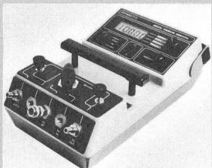
Handpumpe und einem Variobalg ausgestattet. Zwei Messbereiche für Spannung und ein Messbereich für Strom ergänzen die Druckmesseinrichtung. Die Druckanzeige ist in vier Einheiten skaliert; Netz- und Batteriebetrieb - auch aus wiederaufladbaren Batterien. Abmessungen:  $305 \times 180 \times 110$  mm, Gewicht 4 kg.
