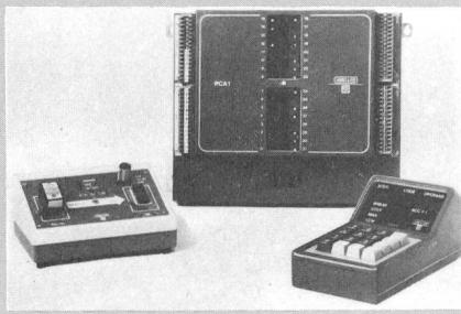
Die Typenreihe PCA 13 weist eine auf 2-K-Worte verdoppelte Speicherkapazität auf. Die Anzahl Ein-/Ausgänge wurde auf maximal 112 erhöht. Mit einem analogen Ein-/Ausgangs-Modul sind neben Steuerungsaufgaben auch Grenzwertüberwachungen und Regelungen mög-
