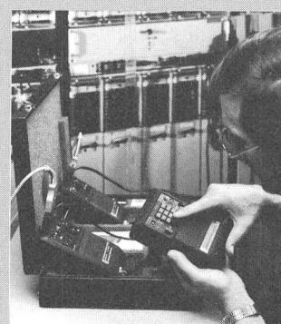
Die kompakte, auch mit Batterien betreibbare Sprecheinrichtung enthält außer dem eigentlichen Sprech- und Mithörteil (Mikrofon und Lautsprecher) auch eine Wählertastatur, die den Betrieb als Fernsprechapparat ermöglicht. Folgende Betriebsarten sind vorgeesehen:
