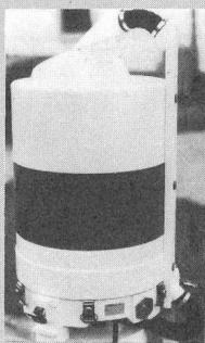
Das Gerät besteht aus der Sende-Empfangs-Einheit für Freiluftaufstellung und einer separaten Steuer- und Recheneinheit mit Anzeigefeld und Kurvenschreiber. Es entspricht den Sicherheitsnormen für lange Wartungsintervalle. Ein automatischer Lüfter hält das Schutzfenster der Sende-Empfangs-Einheit auch bei schwierigen Witterungsverhältnissen frei von Regen oder Schnee. Selbstprüf- und Störungsanzeigen sind eingebaut. (Asea AG, 8048 Zürich)
