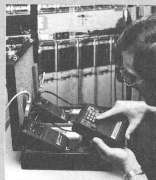
Die kompakte, auch mit Batterien betreibbare Sprecheinrichtung enthält außer dem eigentlichen Sprech- und Mithörteil (Mikrofon und Lautsprecher) auch eine Wähltastatur, die den Betrieb als Fernsprechapparat ermöglicht. Folgende Betriebsarten sind vorgeesehen:
