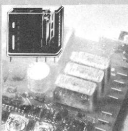
waschfest, zur Reinigung mit Druckwasser und im Ultraschallbad, mit dichtem Relaisboden für problemloses Bandlöten.
