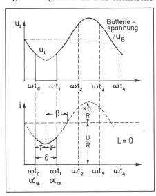
Fig. 7 Idealisierter Verlauf von Schalterspannung  $u_8$  und Wicklungsstrom i
