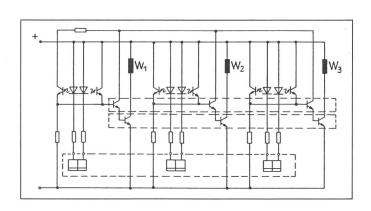
Fig. 13 Kommutierungsschaltung mit zufallsbedingter Redundanz für die Erfassung der Rotorposition
