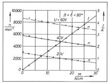
Fig. 11 Drehzahl-Drehmoment-Kennlinien
