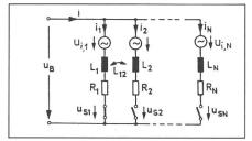
Fig. 8 Ersatzbild des N-strängigen Motors
