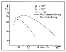
Fig. 6 Wirkungsgrade für Stern- und Brückenschaltung
