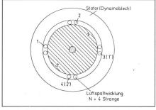
Fig. 1 Prinzipskizze des viersträngigen bürstenlosen Gleichstrom-Kleinmotors
