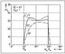
Fig. 10 Momentanverlauf des normierten Drehmoments
