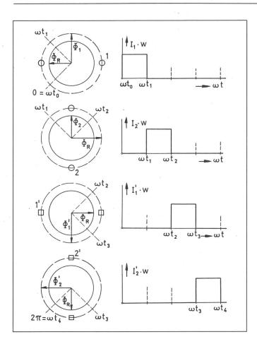
Fig. 2 Zeigerdiagramme für viersträngigen Motor
