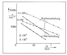
Fig. 5 Drehzahl-Drehmoment-Kennlinien bei Stern- und Brückenschaltung der Wicklungen
