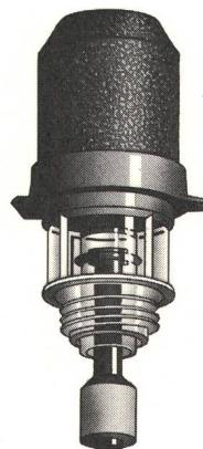
**Fillmeter AntiEx.** Dieser praktische Verschlusspropfen muss nicht abgeschraubt werden und ermöglicht das direkte Ablesen des Säurestandes, Messen der Säuredichte und der Temperatur. Wasser kann direkt eingefüllt werden. Die kippbare AntiEx-Kappe schützt vor Explosionsgefahr.
