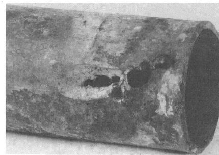
Fig. 3 Die korrodierte Guss-Wasserleitung
