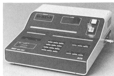
Fig. 6 Einfacher Testanrufbeantworter NQTE für die Verwendung in kleinen Ortszentralen
