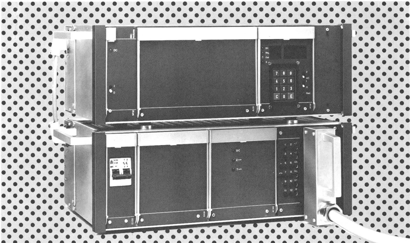
**Das Prüfgerät XS92 eignet sich besonders für Prüfung von elektronischen Distanzrelais und Relais zweier Messgrößen. Es liefert die korrekte Nachbildung von drei Phasenspannungen und eines Phasenstromes in der gesamten R/X-Ebene (0...360°) und gestattet die Eingabe verschiedener Systemverhältnisse sowie die sprunghafte oder stetige Änderung der Prüfgrößen. Direkte Ein- und Ausgaben der Parameter frontseitig.**
