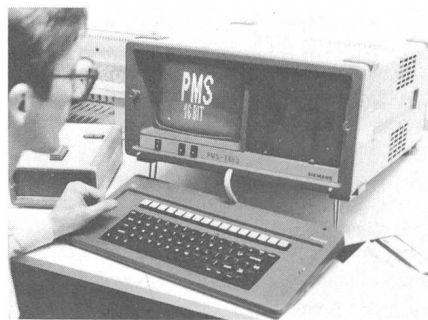
Das portable Test- und Entwicklungssystem von Siemens basiert auf einer Standardbaugruppe mit dem SAB 8088 als Zentralprozessor
