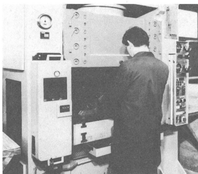
Stanzmaschine mit Unfallschutz-Lichtvorhang
