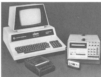
Combilog-Messdatenauswertung mit CBM-Rechner
