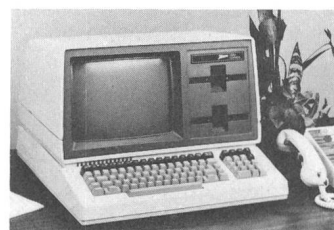
Computersystem der Z-100-Serie mit eingebautem 11,2-MB-Winchester
