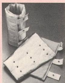
Messungen in der Kunststoffindustrie haben ergeben, dass diese Zylinder, je nach Grösse, Leistungen bis 30 kW abstrahlen! Ebenso beachtlich ist der Gewinn durch eine hochwirksame Isolation mit integrierten Thermobarrieren: Senkung der Abstrahlleistung auf rund 5,2 kW, also um rund 80%!
