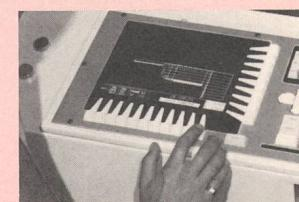
Die Steuerung hat sich im harten Einsatz bei amerikanischen Werkzeugmaschinen-Herstellern bereits bewährt und eignet sich auch vorzüglich für die Erneuerung von veralteten Drehbanksteuerungen. Die wichtigsten technischen Daten sind:
