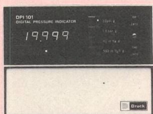
Die Druckbereiche sind von 0...75 mbar bis 0...350 bar wählbar und werden mit einer Genauigkeit von besser als ±0,04% vom Endwert (bis 35 bar) angezeigt. Die Druckaufnehmer sind intern eingebaut oder extern anzuschliessen. BCD- und Analogausgänge, Spitzenwertanzeige, Akku-Stromversorgung, Anschluss eigensicherer Druckaufnehmer usw. sind weitere Möglichkeiten für den vielseitigen Einsatz des DPI 101.
