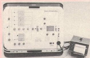
Diese Ausbildungsmittel werden mit Erfolg auch in Fach- und Berufsschulen eingesetzt. Der abgebildete Regelkreismodell-Koffer beispielsweise ermöglicht die Simulation von Regelvorgängen mit verschiedenen Reglerverhalten (P, PI, PID, PD, 2-Punkt) mit einstellbaren Regelparametern und die Aufnahme des Frequenzgan-
