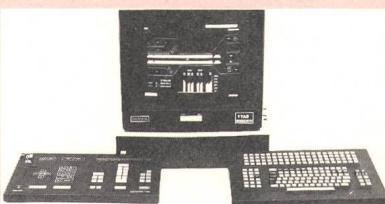
Das Farbbildschirmsystem Sattcon 800 ergänzt die Familie der speicherprogrammierbaren Steuerungen PBS. Sattcon 800 dient der Kommunikation zwischen Mensch und Prozess. Das Farbbildschirmsystem zeigt dynamisch das Abbild des Gesamtprozesses oder eines Prozessabschnitts. Über die Steuersonsole kann in den Prozess eingegriffen werden: durch Stellen von Ventilen, Schalten von Motoren oder Verändern
