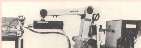
Der ASEA-Roboter IRB 6/2 kann, z.B. zur Motorenmontage, mit einem Druckluft-Schraubenzieher bestückt werden. Die Schrauben werden einem Magazin entnommen und über einen Schlauch auto-
