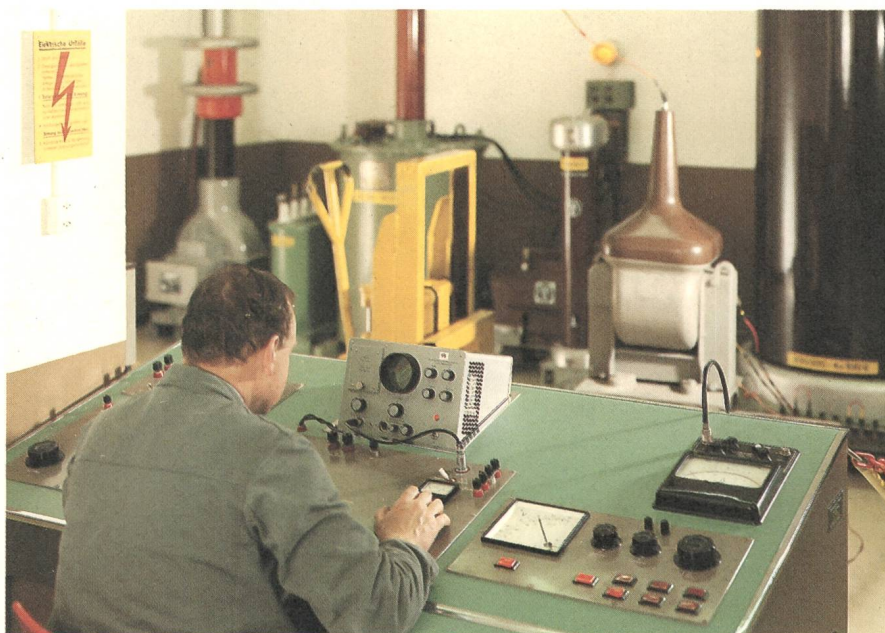
Vérification d'un transformateur de mesure
