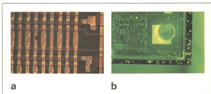
Fig. 7 Défauts dans la métallisation (a), dans le bonding et dans la couche de passivation (b) d'une mémoire
