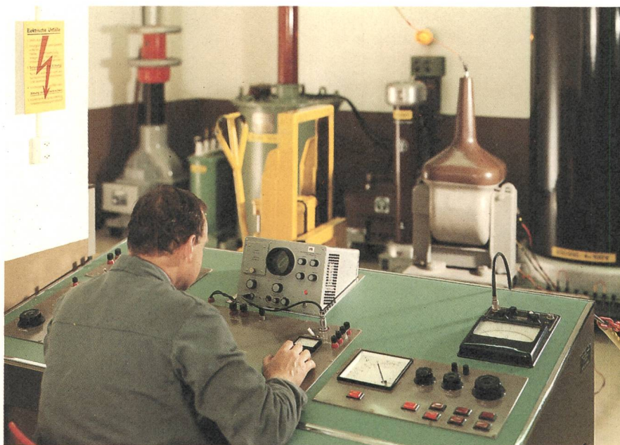
Amtliche Prüfung eines Spannungswandlers im Messwandlerlabor
