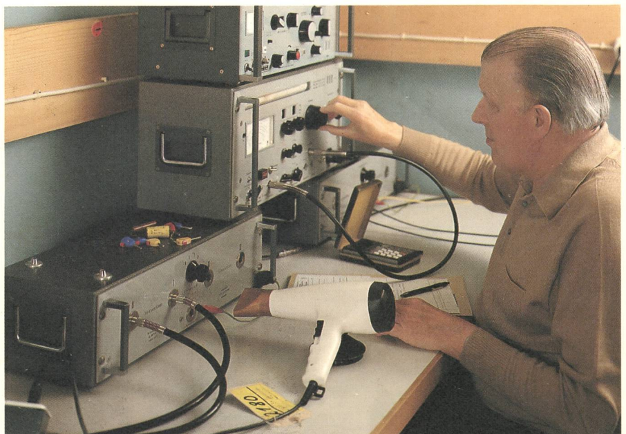
Radiostörschutzmessung an einem Haartrockner
