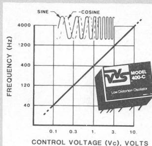
zielbare Abstimmgenauigkeit ist gross und der Klirrfaktor äusserst klein. Ermöglicht wurden diese Eigenschaften durch Verwendung einer neuen Technologie mit spannungsabhängigen Konduktanzen.
