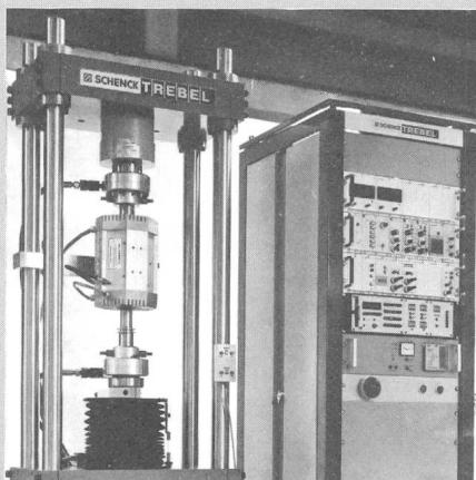
Verantwortlich für Schäden bei zyklischen Belastungs- bzw. Temperaturänderungen mit niedriger Spannungsamplitude sind häufig örtliche plastische Wechselverformungen (Kurzeitermüdung, Low Cycle Fatigue). Von der Schenck Trebel GmbH, Ratingen, wurde für die Untersuchung des Werkstoffverhaltens bei solchen Beanspruchungen die elektromechanische Prüfmaschine RMC 100 entwickelt. Beim Standardversuch werden die LCF-Kennwerte an ungekerbten zylindrischen Probestäben im deh-
