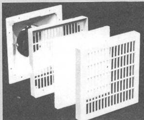
Als Filtermaterial werden Viledon-Filtermatten P15/500 verwendet. Bei Staubkorngrösse <5-10 µ (extrem feiner Staub) kann eine zusätzliche, dünne Filtermatte T3/290 (P15/500 + T3/290) eingesetzt werden (geringere Luftfördermenge). Das Gehäuse besteht aus wärmebeständigem ABS-Kunststoff (-35 ° bis +85 °C), selbstverlöschend nach UL 94 VO.
