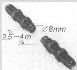
Der Sender ist in zwei verschiedenen Ausführungen erhältlich: mit sichtbarem Rot- oder unsichtbarem Infrarotlicht. Sender und Empfänger sind für den Anschluss an 10...45 V= ausgelegt. Der Empfänger spricht auf beide Lichtarten an. Die Reichweite beträgt für sichtbares Rotlicht 2,5 m und für Infrarotlicht 4 m.
