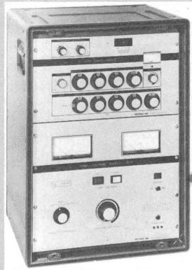
Das komplette Messsystem vom Typ 2808/5282 besteht aus teilentladungsfreier Hochspannungsspeisung mit eingebautem Normalkondensator und der eigentlichen Messbrücke, eingebaut in einem einzigen stossgedämpften Gehäuse oder in zwei feldtauglichen, getrennten und tragbaren Metallgehäusen. Die notwendigen Kabelsätze sind in der Lieferung inbegriffen.
