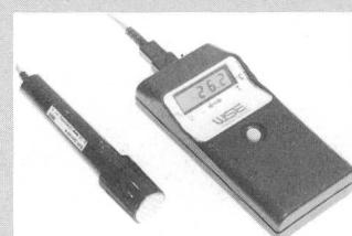
Feuchte. Mit einem Schiebeschalter an der Messsonde kann die Temperatur im Bereich von  $-25,0 \dots + 50,0^\circ\text{C}$  angezeigt werden. Das Gerät im handlichen und robusten Kunststoffgehäuse wiegt nur 210 g und benötigt einen 9-V-Block für eine Betriebsdauer von etwa 200 h.
