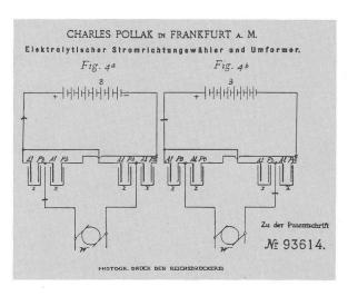
Fig. 2 Die Gleichrichterbrücke von Ch. Pollak, 1896 [5]
