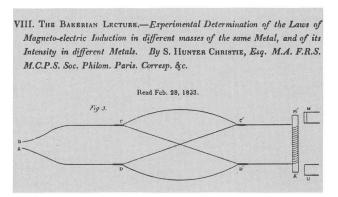
Fig. 1 Die erste Brückenschaltung zu Messzwecken von S.H. Christie, 1833 [2]
