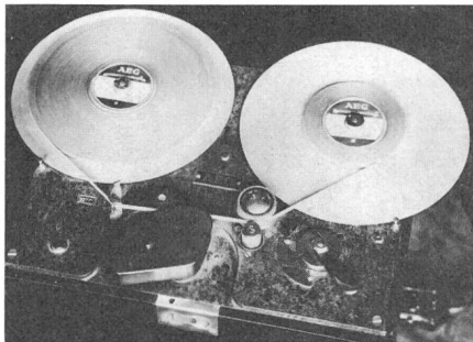
Fig. 2 Die «K3», eines der ersten transportablen Tonbandgeräte
