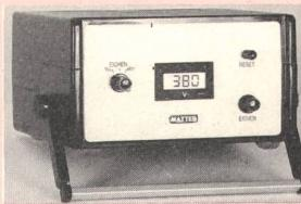
Kurz die wichtigsten Daten: Eingangsspannung: 180...420 V, 45...65 Hz; Spannungsabsenkungsbereich: 0...199,9 V; Genauigkeit: 0,5%; LCD-Anzeige 12,5 mm hoch. Das Messgerät ist in einem schlagfesten Kunststoffgehäuse mit Traggriff aufgebaut und hat ein fest verbundenes Zuleitungskabel mit doppelt isolierten Krokodil-Klemmen. (Ulrich Matter AG, 5610 Wohlen)
