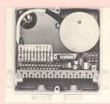
Der Melder besteht aus der wasserdicht vergossenen Auswerte-Einheit, welche in ein Kombigehäuse eingesetzt wird, und dem Körperschall-Geber, der zur Fernprüfung dient. Die Aufputzausführung des VF2 lässt sich mit wenigen Zubehörteilen auch als Einbau- oder Fussbodenversion einsetzen sowie auf Metallflächen montieren. Die Melderempfindlichkeit kann individuell den Umgebungsbedingungen angepasst werden.
