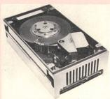
Das Interface ist kompatibel mit dem Lark Drive von Control Data (kombinierte Festund Wechselplatte), der in Ausführung von 8 + 8 MByte und 25 + 25 MByte angeboten wird. Der Windsor 9412 kann, ebenso wie der Lark 9455/9457, mit einem Adapter an das Standard Storage Module Drive (SMD) Interface angeschlossen werden. Die MTBF beträgt 10 000 h.
