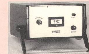
Kurz die wichtigsten Daten: Eingangsspannung: 180...420 V, 45...65 Hz; Spannungsabsenkungsbereich: 0...199,9 V; Genauigkeit: 0,5%; LCD-Anzeige 12,5 mm hoch. Das Messgerät ist in einem schlagfesten Kunststoffgehäuse mit Traggriff aufgebaut und hat ein fest verbundenes Zuleitungskabel mit doppelt isolierten Krokodil-Klemmen. (Ulrich Matter AG, 5610 Wohlen)
