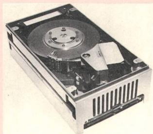
Das Interface ist kompatibel mit dem Lark Drive von Control Data (kombinierte Fest- und Wechselplatte), der in Ausführung von 8 + 8 MByte und 25 + 25 MByte angeboten wird. Der Windsor 9412 kann, ebenso wie der Lark 9455/9457, mit einem Adapter an das Standard Storage Module Drive (SMD) Interface angeschlossen werden. Die MTBF beträgt 10 000 h.
