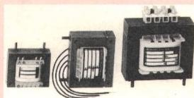
Die Gewindegelenkbolzen werden unmittelbar auf den Eisenkern des Transformatoren geschweisst und dienen als Chassisbefestigung desselben. Die Chassismontage wird dadurch außerordentlich vereinfacht: Der Transformator positioniert sich von selbst, keine Langlöcher, beansprucht keine zusätzliche Chassisfläche.
