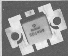
stände sowie der Goldmetallisierung verträgt der SD 1499-1 unendlich hohe Stehwellenverhältnisse in allen Phasenlagen bei hoher Kollektorspannung (15,5 V). Der Transistor ist im Flanschgehäuse .500 6L FL aufgebaut. (Modulator AG,
