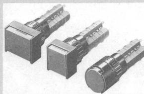
Die Baureihe 51 ist in den Frontabmessungen 18 x 24 mm, 18 x 18 mm und Ø 18 mm lieferbar. Bewährte Schaltelemente wie Sprung-, Low-Level- und Hallschalter sind mit diesen Tasten verwendbar und ergeben dadurch die Möglichkeit eines Schaltbereiches von einigen  $\mu$ A/ $\mu$ V bis 5 A/250 V.
