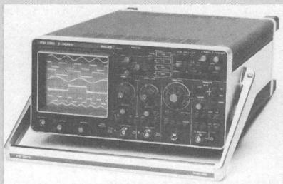
Die Einsatzmöglichkeiten der digitalen Speicheroszilloskope werden wesentlich durch die maximale Abtastrate bestimmt. Das Digitalspeicheroszilloskop PM 3311 von Philips mit einer Abtaffrequenz von 125 MHz erweitert den möglichen Anwendungsbereich beträchtlich. Durch den Einsatz der P<sup>2</sup>CCD-Technologie wurde es möglich, Hochgeschwindigkeitsabtastung mit preisgünstiger Speicherung zu kombinieren.
