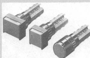
Die Baureihe 51 ist in den Frontabmessungen 18 × 24 mm, 18 × 18 mm und Ø 18 mm lieferbar. Bewährte Schaltelemente wie Sprung-, Low-Level- und Hallschalter sind mit diesen Tasten verwendbar und ergeben dadurch die Möglichkeit eines Schaltbereiches von einigen  $\mu\text{A}/\mu\text{V}$  bis 5 A/250 V.
