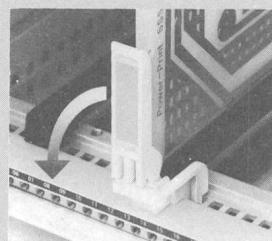
Eine im Auszuggriff eingelassene Vertiefung nimmt die gut zu beschriftende Selbstklebe-Etikette samt farbigem Sichtfenster auf. Entriegelt wird die Kartensicherung durch einfachen Fingerdruck oder, in Kombination mit einem Auszuggriff, durch dessen Ausschwenken. Auszuggriff, Kartensicherung und Kartenführung bilden eine Einheit, können aber auch einzeln bezogen werden.
