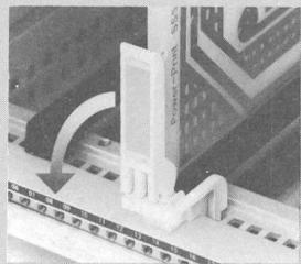
Eine im Auszuggriff eingelassene Vertiefung nimmt die gut zu beschriftende Selbstklebe-Etikette samt farbigem Sichtfenster auf. Entriegelt wird die Kartsicherung durch einfachen Fingerdruck oder, in Kombination mit einem Auszuggriff, durch dessen Ausschwenken. Auszuggriff, Kartsicherung und Kartenführung bilden eine Einheit, können aber auch einzeln bezogen werden.
