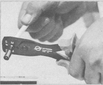
Kein mühsames Zusammenstecken von Koaxialstecker-Einzelteilen mehr, sondern unkompliziertes, sekundenschnelles Crimpeln (Anklemmen) von Koaxsteckern an Koaxialkabel mit der Crimp-Zange: dies ermöglichen die neuen Crimp-Stecker von Astro.
