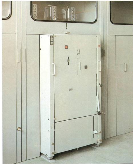
Allseitig geschlossene Zellen für maximalen Personenschutz – Schutzgrad IPH 3, Sichtfenster aus Sekuritglas, Explosionsklappen nach oben öffnend. Widerstandsfähige Einbrennlackierung für anspruchsvolles Design und hohen Korrosionsschutz. Abmessungen (B x T x H) nur 1200 x 1200 x 2100 mm.
